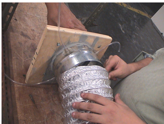
Figura 28 – Colarinho com tomadas de pressão
